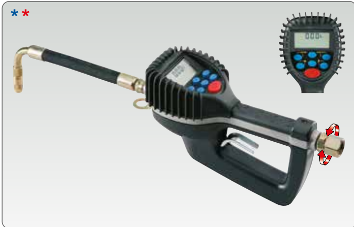
Art. 37704 Pistola dosatrice digitale a preselezione per olio, dotata di: - snodo entrata F 1/2" - terminale flessibile - ugello semiautomatico ø 16 mm
