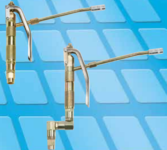
Art. 66882 Pistola grasso con terminale rigido entrata F 1/4", Art. 66663 snodo triplo con testina grassaggio speciale 4 griffe
