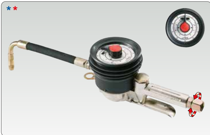
Art. 37703 Pistola con contalitri meccanico per olio (Art. 37701) dotato di: - snodo entrata F 1/2" - terminale flessibile - ugello semiautomatico ø 16 mm
